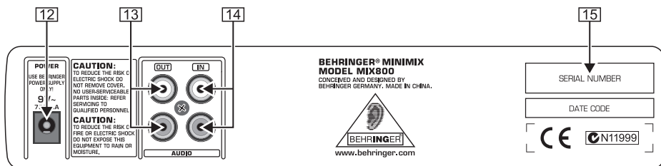
Fig. 2,2: Collegamenti sul lato posteriore del MIX800
