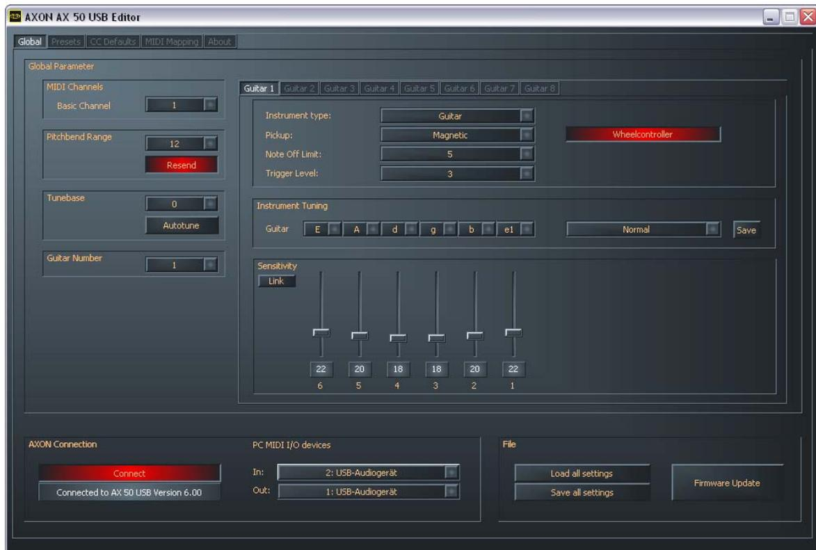
**Basic Channel (1-16):** qui si predefinisce il primo dei 6 canali MIDI (uno ciascuno per corda). Tutti gli altri canali seguono automaticamente in ordine crescente. Se ad esempio si sceglie un "1", allora l'AXON riserva i canali MIDI da 1 a 6. Il valore 5 occuperebbe di canali MIDI da 5 a 10 e il valore 11 i canali da 11 a 16. Normalmente è preimpostato un valore pari a 1.
