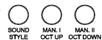
**10.[MAN.II OCT DOWN]:** Traspone di un'ottava in basso le note suonate sul Manuale II, indipendentemente dallo stato dello Split.
